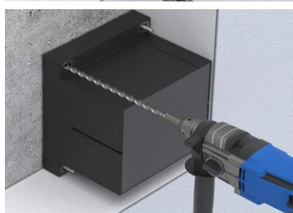
Per la piastra per carichi elevati SLK®-ALU-TQ inserire un'asta filettata per iniezione nel foro corrispondente della piastra per carichi elevati SLK®-ALU-TQ e praticare il terzo e quarto foro.
