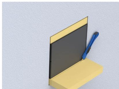
Füllstücke einschieben und fassadenbündig ablängen.
