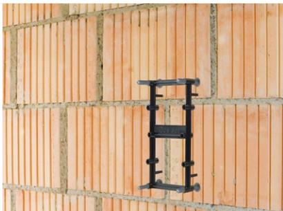
Gewindestangen setzen und durch Aufstecken der Setzlehre für UMP® genau ausrichten. Injektions-Mörtel aushärten lassen. Nach dem Aushärten Setzlehre abziehen und überschüssiges Material entfernen. Bei Mauerwerk mit Lochsteinen müssen zwingend Injektions-Ankerhülsen verwendet werden.
