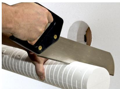
Tagliare del cilindro di montaggio VARIZ® con una sega a mano o un dispositivo di taglio a filo caldo rendendo il loro spessore isolante su misura.
