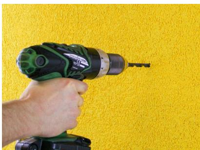
In caso di viti con diametro elevato, una preperforazione potrebbe risultare oppor-tuna poiché si evita il rischio di taglio del cilindro di montaggio Rondoline®-PU.
